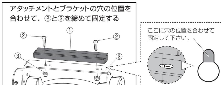
2. 変換アタッチメントを付けたリール本体を取付ベース板に設置してください。
